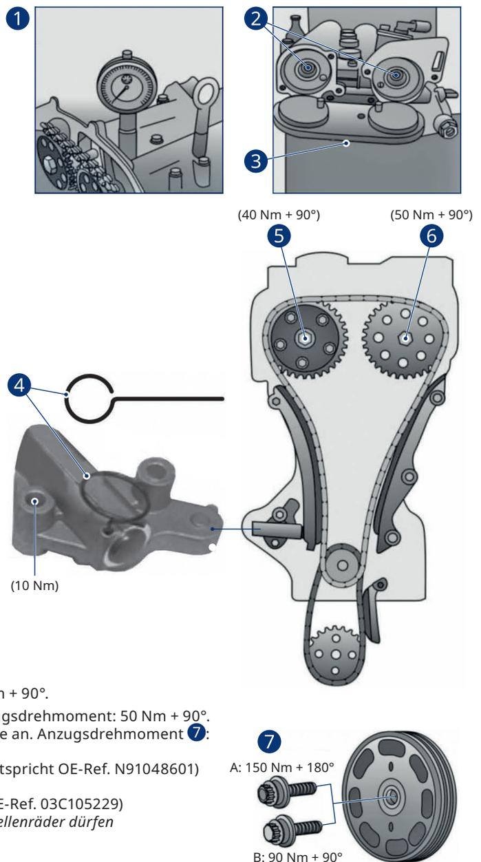
! **Der in diesem Kit enthaltene Kettenspanner ist federbelastet und kann bei unsachgemäßer Handhabung Schäden verursachen. Entfernen Sie den Stift NICHT bevor der Kettenspanner vollständig montiert ist und stellen Sie stets sicher, dass der Kolben innerhalb einer Reichweite von 20 Metern von Ihnen und anderen Personen weg zeigt.**
